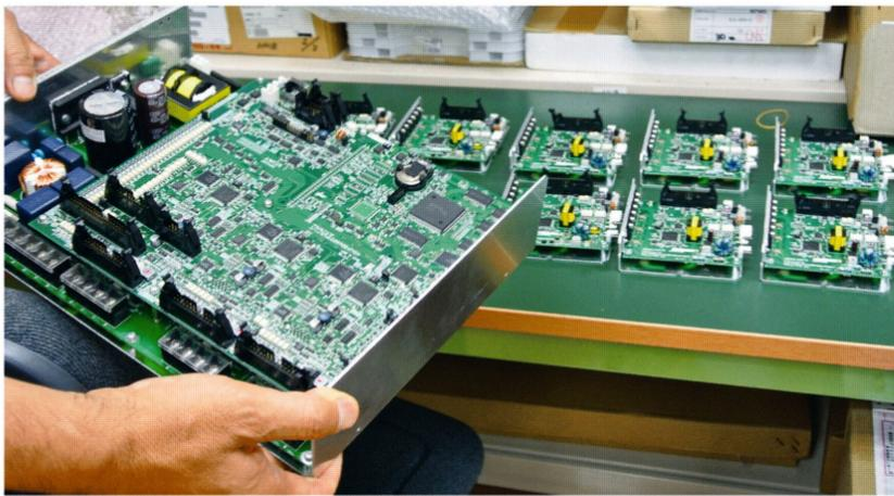
出荷検査されるACサーボドライバ。3軸のモーターを制御できる
